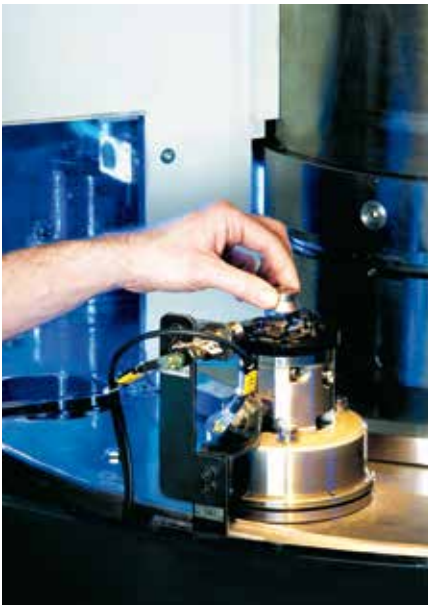
Handbeladung mit Sicherheitslichtvorhang und automatischer Abschaltung
