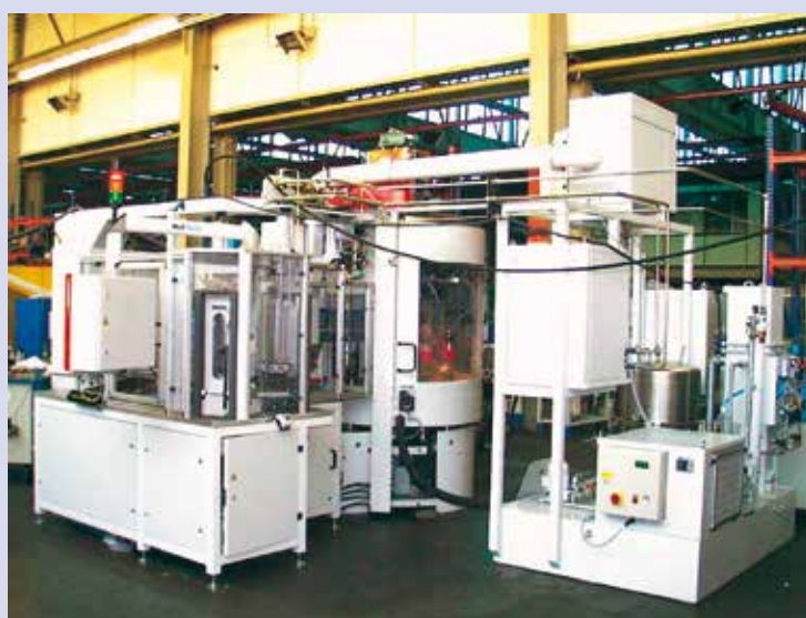
MicroStar mit Automationszelle aus Schüttgut in Stapelpalette mit Preprozess- und Inprozess-Messsteuerung sowie SPC-Teileschleuse
