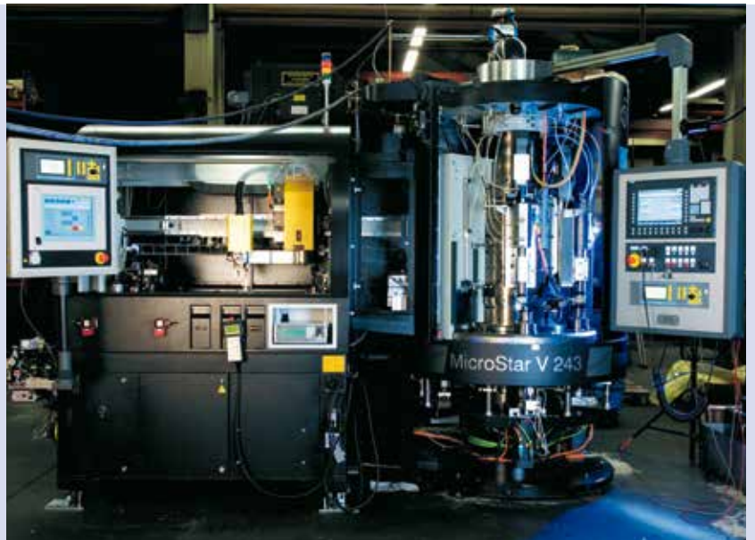
MicroStar mit Automationszelle und integrierter Stift-Einpressereinheit für Einspritzbauteil
