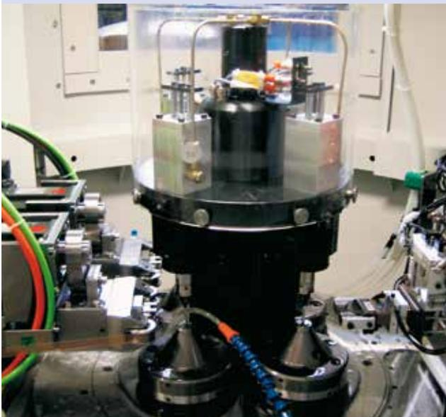
采用金钢石砂带加工针型阀芯
