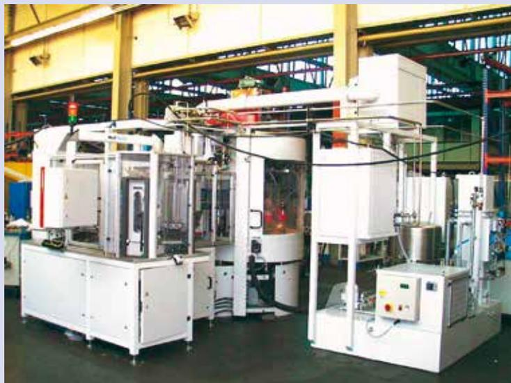
配给MicroStar的全自动操作台实现工件放入工件托盘,输送到机床,经预测量,在线测量等到达SPC托盘
