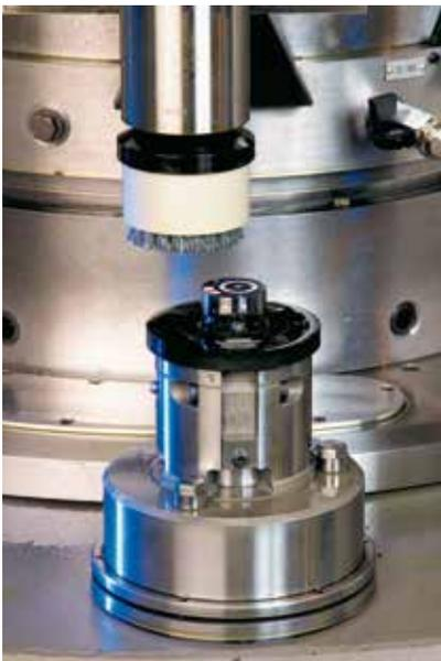
梯轮豪斯的专利技术—采用砂带复合加工燃油喷射系统零件(如图加工密封座)
