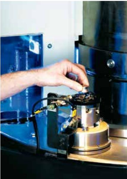
有安全光栅和自动停机功能的手工上下料工位
